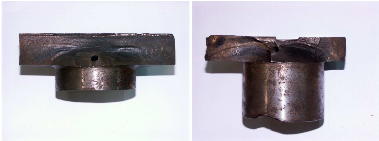
Rys.10. Przykłady przełomów zmęczeniowych - widoki.
