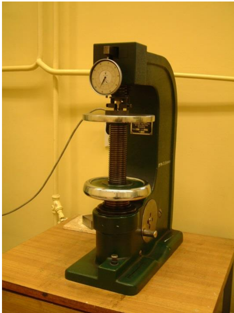
Rys.10. Ogólny widok twardościomierza Rockwella i jego powiększony fragment
