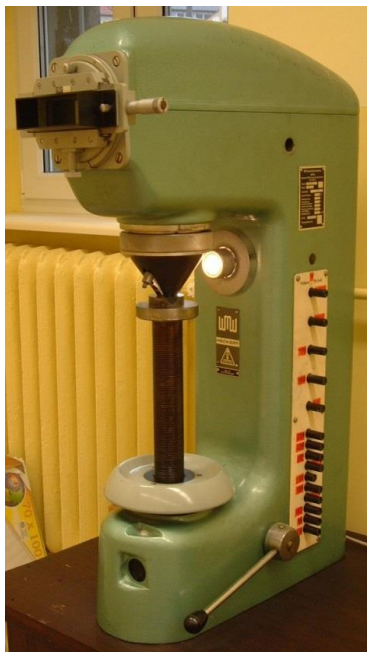
Rys.6. Ogólny widok twardościomierza do pomiarów twardości metodą Brinella i Vickersa
