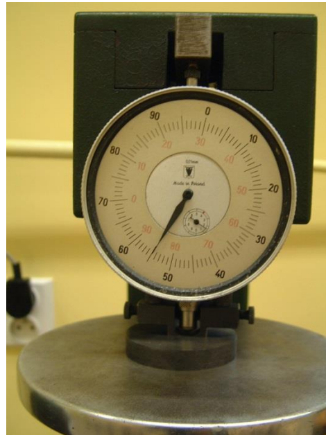
Rys.10. Ogólny widok twardościomierza Rockwella i jego powiększony fragment
