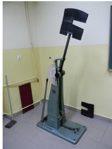
Rys.6. Widok młota wahadłowego typu Charpy
