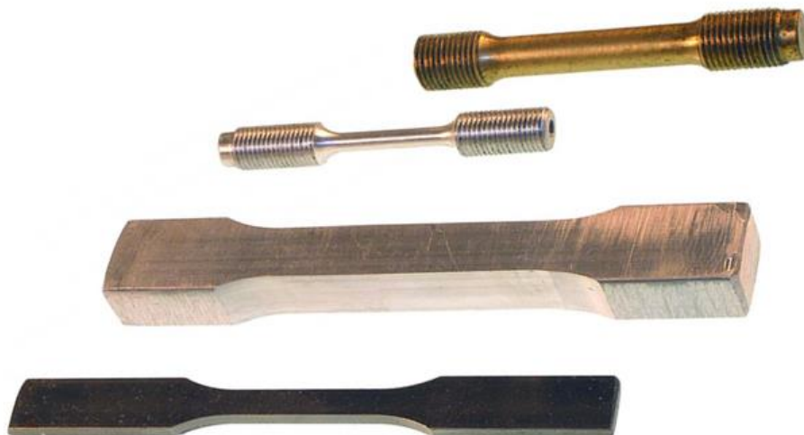
Rys.3. Próбка na rozciąganie z żeliwa szarego
