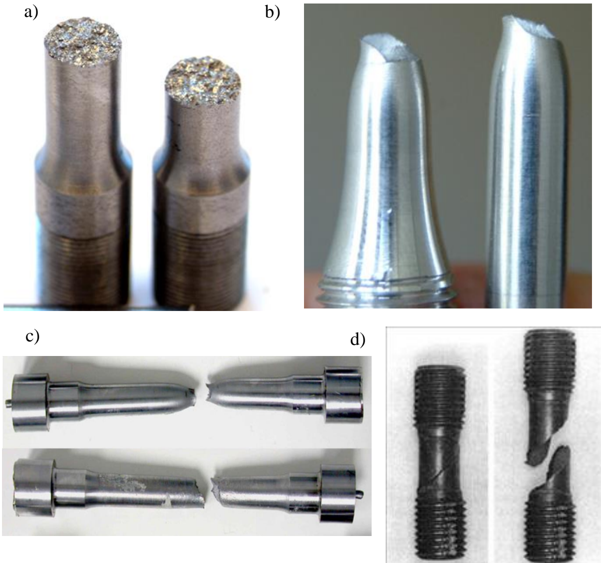
Rys. 16 . Przykłady przełomów próbek po próbach rozciągania [7,8,9]
