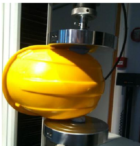
Rys. 7. Próba ściskania przemysłowych kasków ochronnych [5]
