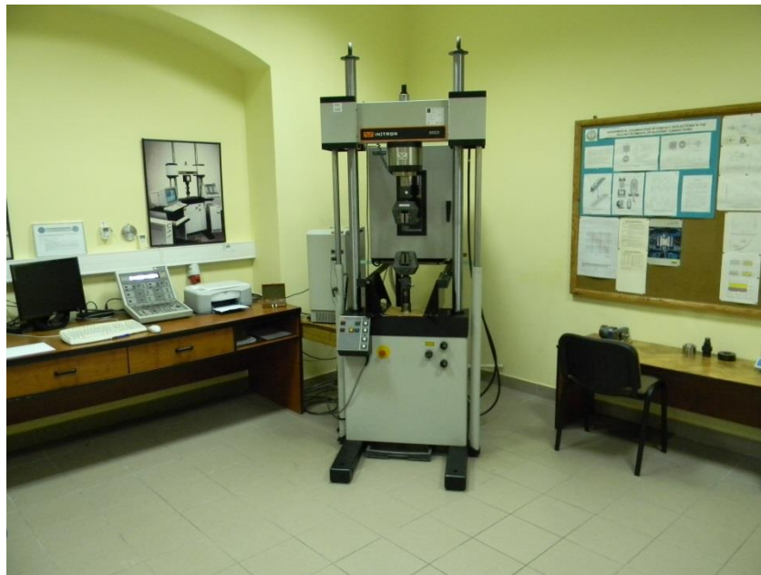
Rys.12. Serwohydrauliczna maszyna do badań wytrzymałościowych firmy INSTRON 8501 o maksymalnej sile obciążającej do 100kN
