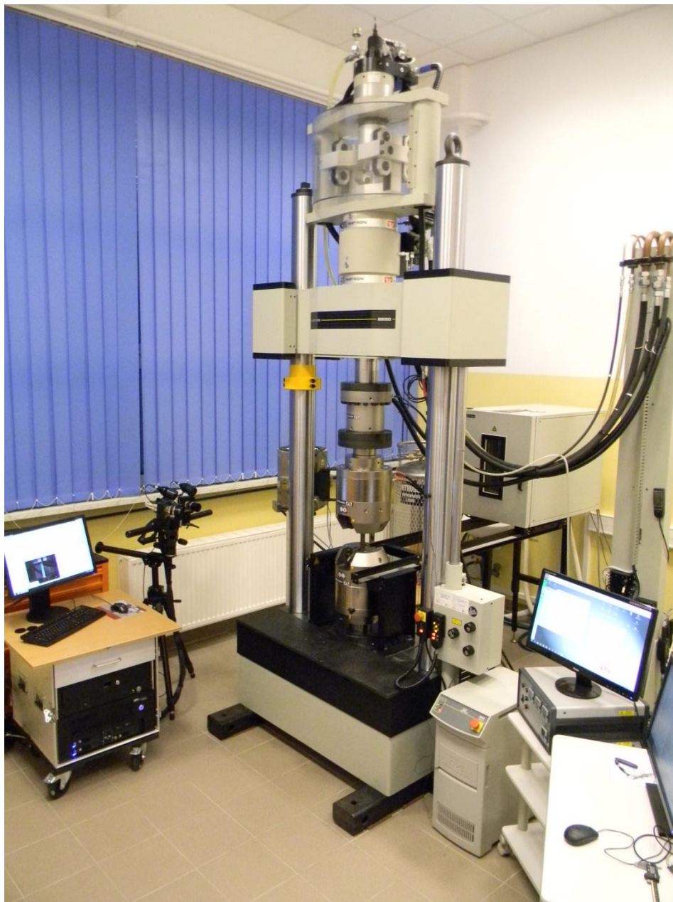
Rys. 16. Uniwersalna serwohydrauliczna maszyna wytrzymałościowa firmy INSTRON 8850
