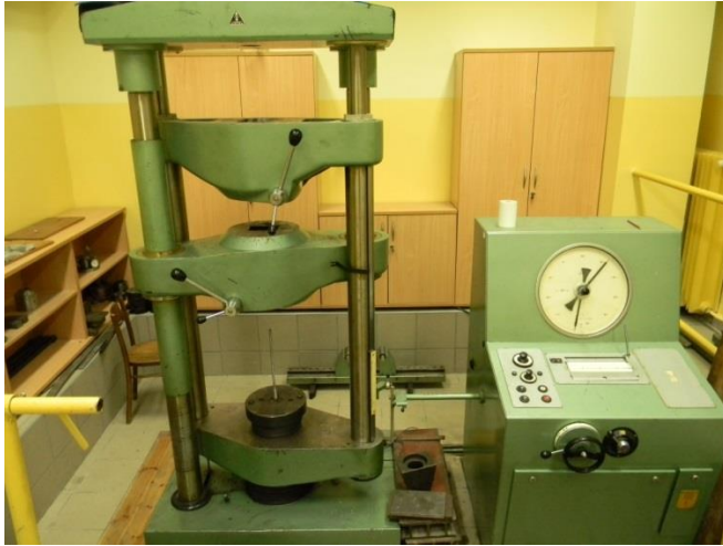
Rys.11. Uniwersalna maszyna wytrzymałościowa ZD 100 z napędem hydraulicznym o maksymalnej sile obciążającej do 1000 kN.
